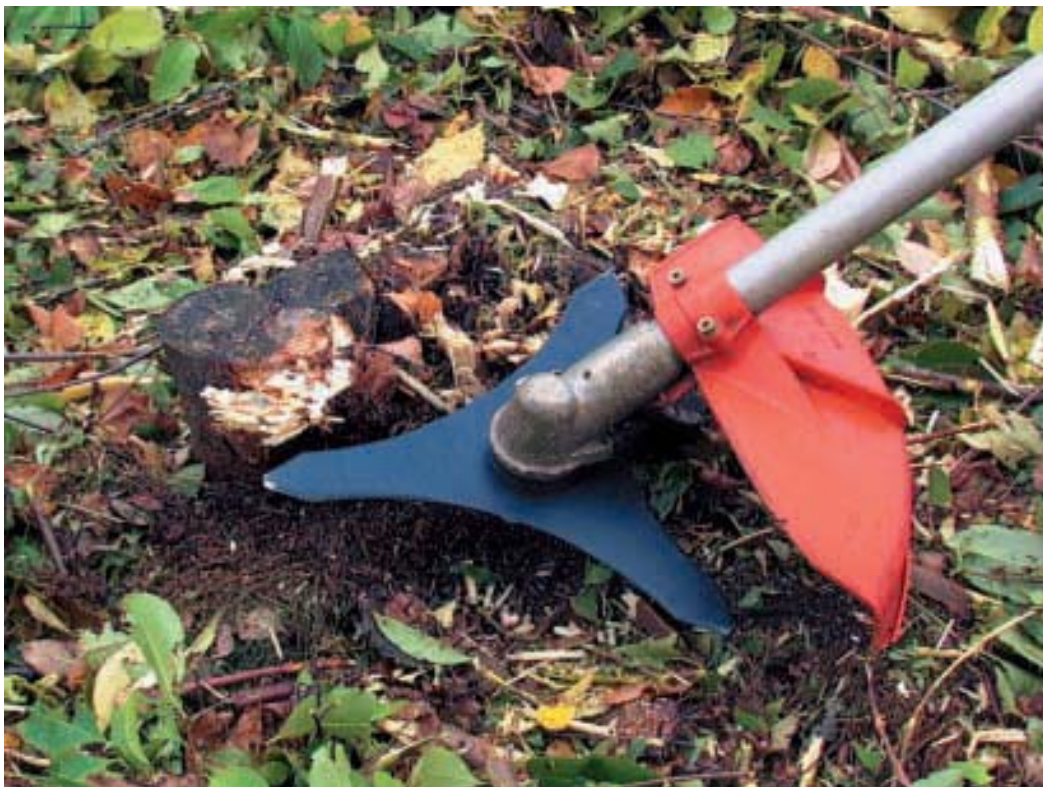
Abbildung 4: Mit dem Dickichtmesser kann auch mehrjähriger Stockausschlag gemäht und der Stumpf anschließend bis in den Boden hinein entrindet werden.
