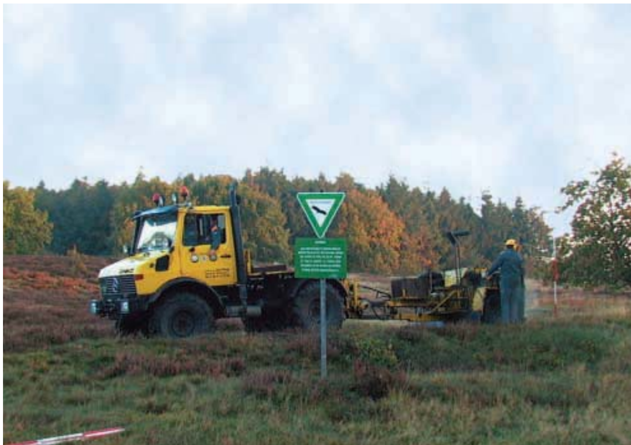
Abbildung 7: Die Stubbenfräse wird von einem schweren Fahrzeuge gezogen und ist nur begrenzt manövrierfähig. Sorgwohlder Binnendünen am 19.10.04
